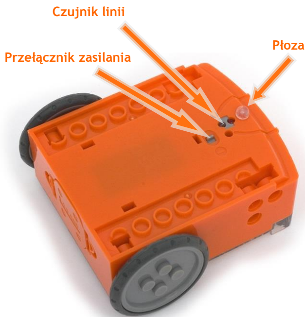
Położenie przełącznika zasilania, płozy i czujnika linii Edisona.
